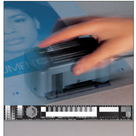
Medición de la plancha utilizando un lector de planchas con la tira de control apropiada para planchas digitales. También se utilizan medidores de punto para la medición de planchas (por ejemplo X-rite ccDOT, Techkon DMS). Foto System Brunner.
